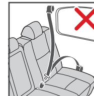
Ceinture sous-abdominale/épaulière avec deux rétracteurs
