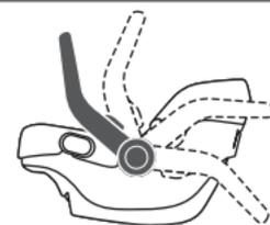
La poignée de transport doit être verrouillée en position véhicule (4) lors de l'utilisation dans le véhicule.
