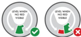
**REMARQUE:** Le véhicule doit être stationné sur une surface plane pour mettre correctement la base à niveau.
