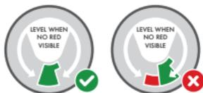
L'angle d'inclinaison est correct. La base est de niveau lorsque seulement du **VERT** est visible entre les deux flèches de l'indicateur de niveau. Aucun **ROUGE** ne doit être visible.
