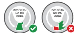
Après avoir fixé le landau à la base, vérifiez que la base est à niveau. La base est à niveau lorsque seul l'indicateur **VERT** est visible entre les deux flèches sur l'indicateur de niveau.
