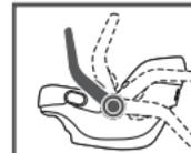
**REMARQUE:** La poignée de transport doit être verrouillée en position véhicule (4) lors de l'utilisation.
