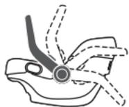
La poignée de transport doit être verrouillée en position de rebond (4e) lors de l'utilisation.
