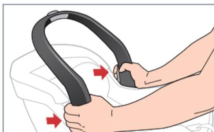
La poignée de transport doit être verrouillée dans l'une des quatre (4) positions suivantes lorsque le siège auto est utilisé en dehors d'un véhicule : **A** pied, **B** rangement, **C** transport et **D** véhicule. La poignée doit être en position véhicule (D) lorsque le siège est installé dans un véhicule. Pour régler la position de la poignée, appuyez sur les deux boutons de réglage et faites pivoter la poignée vers l'avant ou l'arrière.
