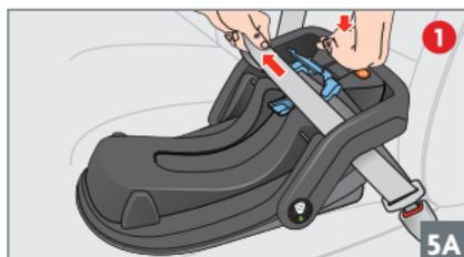
**ÉTAPE 5A :** Tenez la sangle d'épaule au-dessus de la base. D'une main, poussez la base vers le creux du siège du véhicule (jonction assiste-dossier) et maintenez-la fermement enfoncée tout en tirant sur la sangle d'épaule
