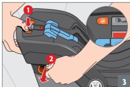
**ÉTAPE 3 :** Repérez les connecteurs des ancrages inférieurs, de chaque côté de la base, puis appuyez sur le bouton de dégagement orange correspondant à chaque connecteur, sur le dessus de la base **1**, tout en tirant le connecteur hors de son logement **2**.
