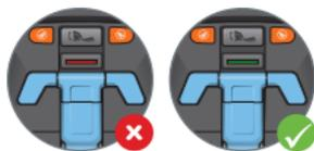
**REMARQUE :** Poussez la base dans le creux du siège (jonction assise-dossier). L'installation est terminée lorsque l'indicateur de serrage passe du rouge au vert et reste vert lorsque vous arrêtez d'appuyer sur la base.
