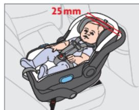
Le haut de la tête de l'enfant ne doit pas être à moins de 25 mm (1 po) du haut de l'appui-tête lorsqu'il est dans la position la plus haute.
