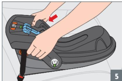
**ÉTAPE 5 :** Appliquez une forte pression sur la base pour permettre aux sangles trop longues des connecteurs de se rétracter et de se resserrer.
