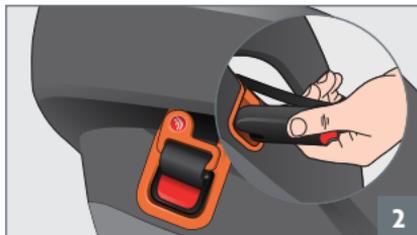
**ÉTAPE 1 :** Appuyez sur le bouton rouge du connecteur d'ancrage inférieur **1** tout en tirant le connecteur hors de l'ancrage du véhicule **2**.
